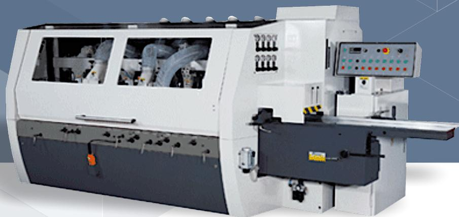
CON 5 MANDRILES HELICOIDALES Y 2 MANDRILES RANURADOS VERTICALES
